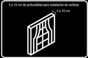
Para realizar el montaje de las cortinas se han dejado entre 5 y 10 centímetros como zona de seguridad considerados desde la instalación de la ventana al interior del departamento donde no existen canalizaciones de instalaciones.
