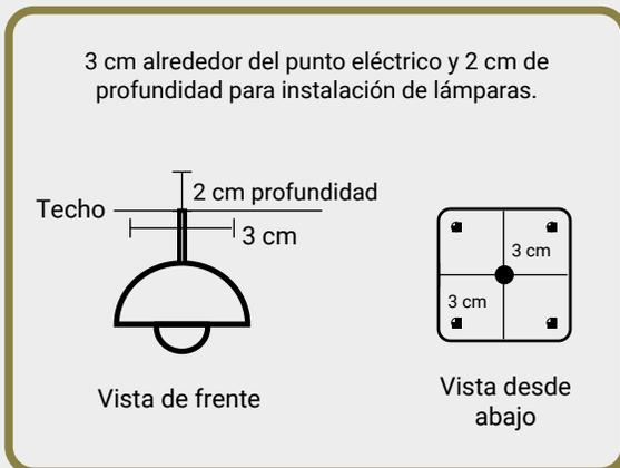
*Para realizar el montaje de las lámparas se han dejado tres centímetros alrededor del punto eléctrico y dos centímetros de profundidad, especialmente libre de ductos eléctricos y agua para dicho efecto.*
