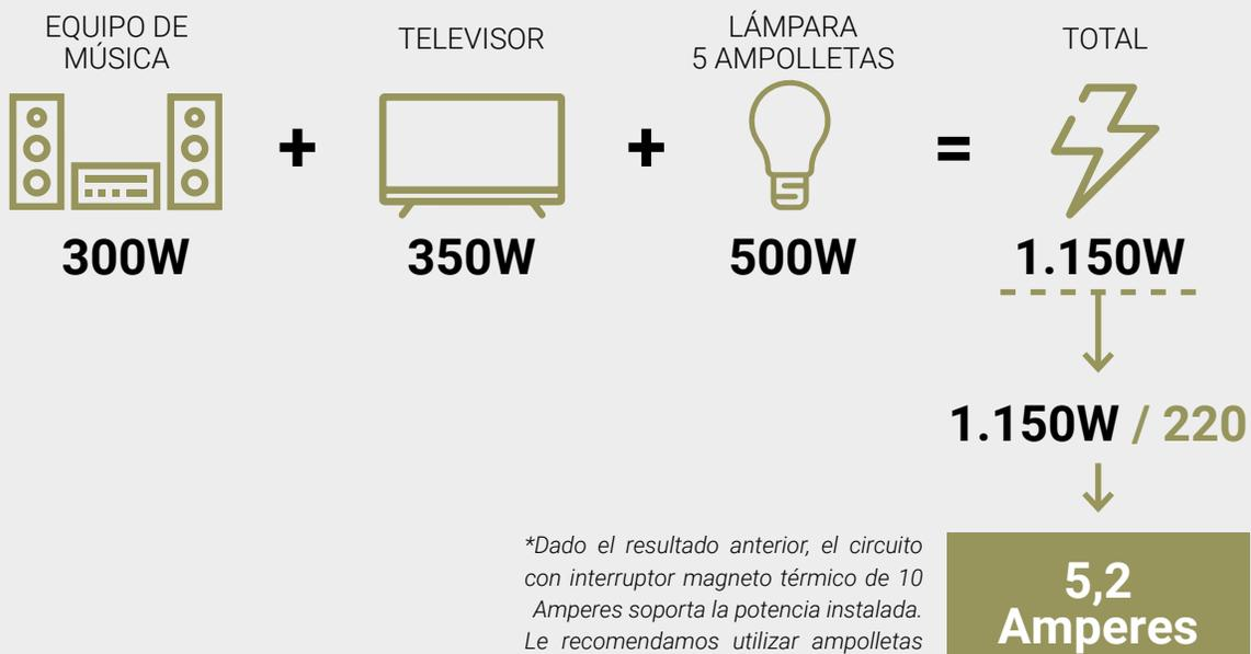
*\*Dado el resultado anterior, el circuito con interruptor magneto térmico de 10 Amperes soporta la potencia instalada. Le recomendamos utilizar ampolletas de bajo consumo o tipo LED.*
