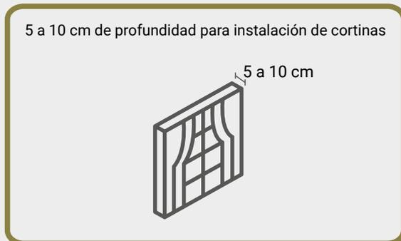
*Para realizar el montaje de las cortinas se han dejado entre 5 a 10 centímetros como zona de seguridad, considerados desde la instalación de la ventana al interior del departamento donde no existen canalizaciones de instalaciones.*
